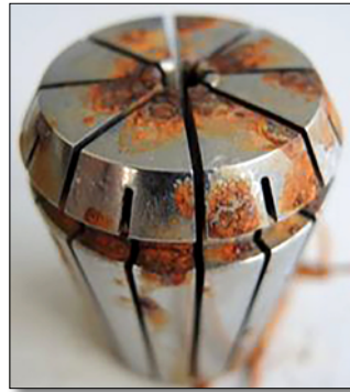
競合他社製ステンレスERコレット(ドイツ製) 素材: DIN1.4034 (SUS420J2)
